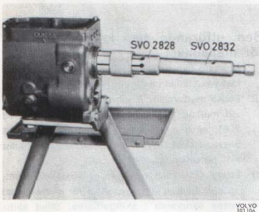
Bild 13. Demontering av huvudaxelns bakre lager M 410
