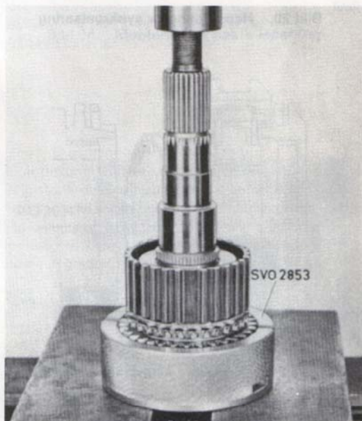
Bild 18. Isärtagning av huvudaxel, I
