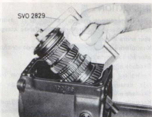
Bild 15. Urluftning av huvudaxel
